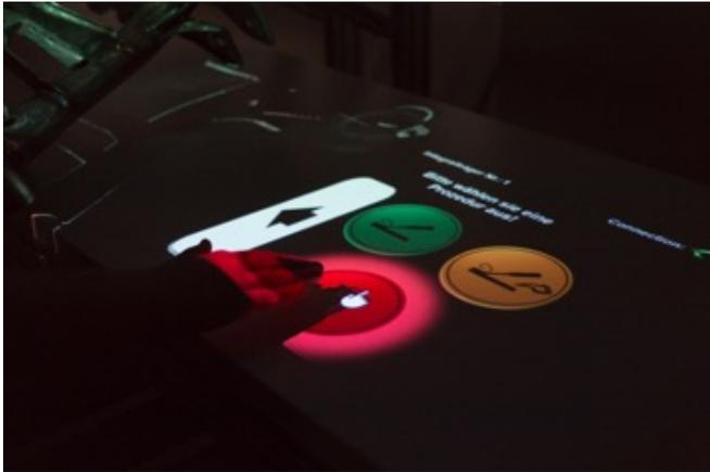
**Abb. 3 Das auf das Bauteil und den Arbeitstisch augmentierte Handgesten-Bedieninterface unterstützt bei der Roboter- und Prozesssteuerung.**
